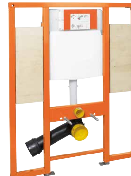
Reservoir element t.b.v. mindervalide toe- passing, compleet met voorgemonteerde plaat elementen voor armsteunen. Geschikt voor vrijwel alle gangbare armsteunen en toiletpotten. Hoogte 1180 mm.
